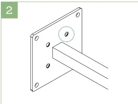
2. Die Konsole GJ 48 / GJ 49 ist mit 4 zusätzlichen Senkbohrungen an der Innenseite, passend zu den Schraubkanälen des Pfostens, ausgestattet.
