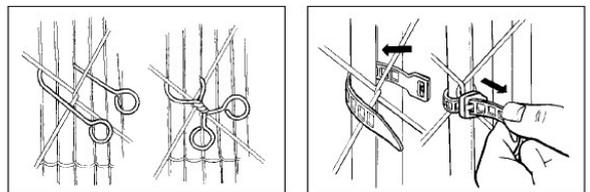
Die Montage mit Befestigungsschlaufen ist einfach und bequem.
